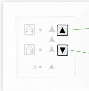
Durch Drücken der Pfeiltaste nach oben wird die Lüfterleistung jeweils um eine Stufe höher geschaltet.
